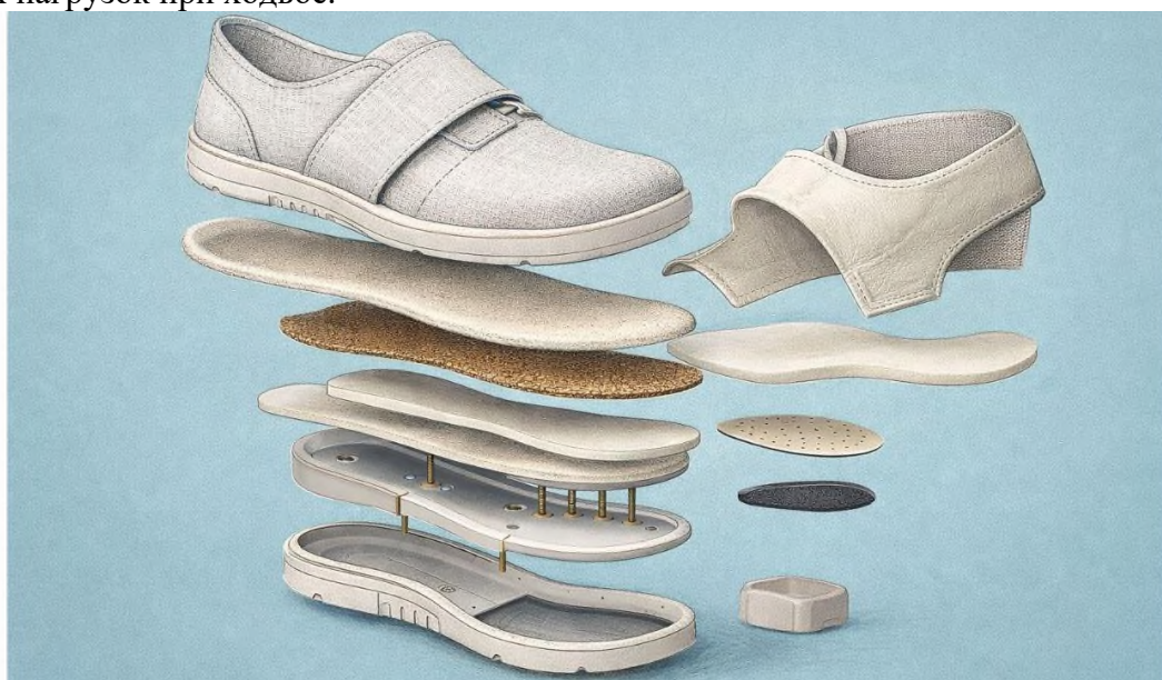
Рис. 2. Слоистая конструктивная структура упрощённой ортопедической обуви для подростков
