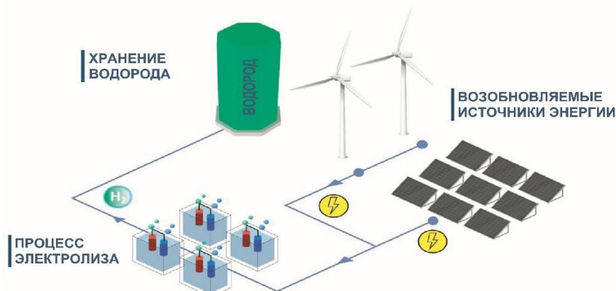
Рис.2. Принципиальная схема электролизной установки для производства водорода с использованием возобновляемых источников энергии
