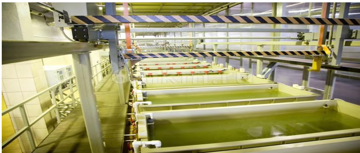
2-rasm. Elektrokimyoviy usul (galvanika vannalari).
