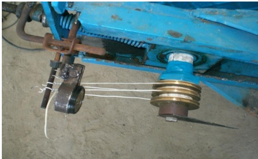
4-rasm. Ishchi valning aylanish tezligini o'lchash qurilmalari.
