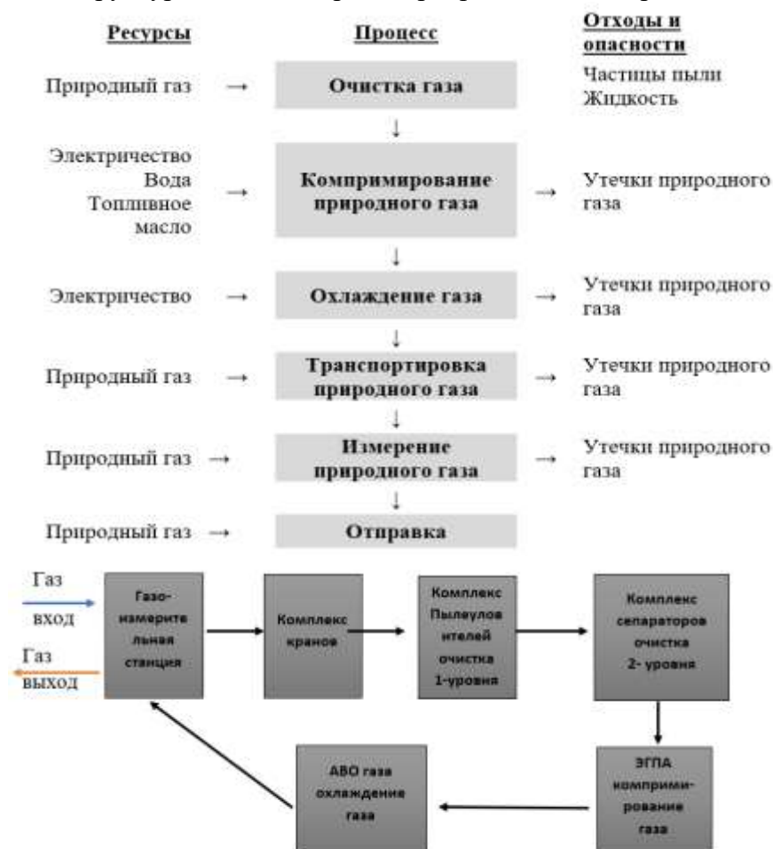
Рис. 1. Структура технологического процесса компримирования природного газа
