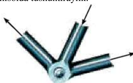
b) sharnirlar vositasida biriktirilgan tugun
