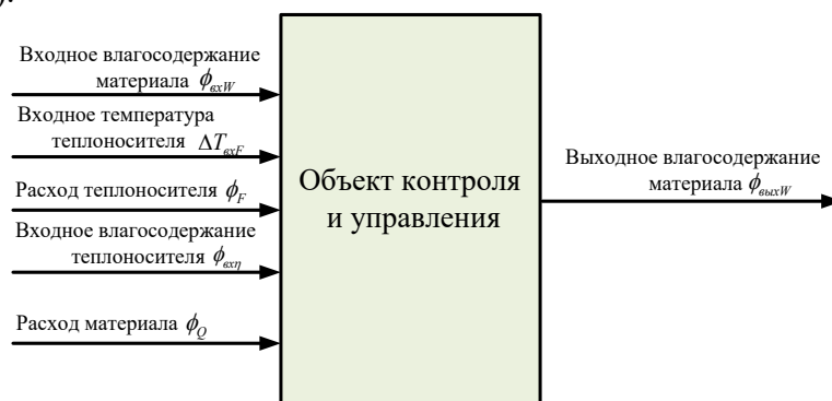
Рис.1. Структурная схема барабанной сушилки как объекта контроля, диагностирования и управления
