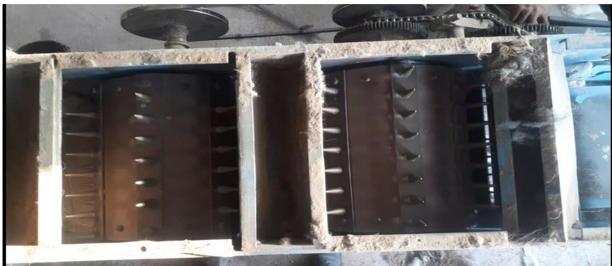
3-rasm. Takomillashtirilgan qoziqchali barabanning qisman ko'rinishi
