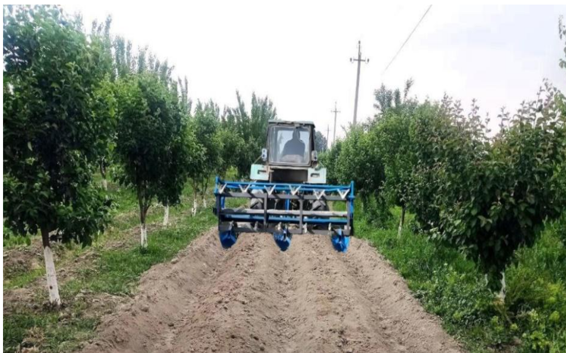
5-rasm. Bog' qatorlari oralariga ishlov beradigan universal qurilmaning pushta olish jarayoni
