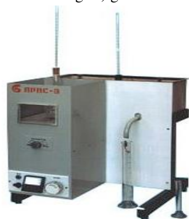
1-rasm. ARNS-1E neft mahsulotlarini fraksiyalarga ajratish laboratoriya qurilmasi
