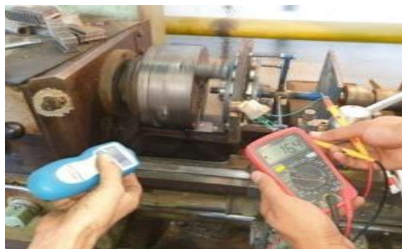
10-расм. Ишлаб чиқилган электр генератор устида ўтказилаётган тажриба-синов ишлари
