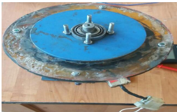
10-расм. Ишлаб чиқилган электр генератор устида ўтказилаётган тажриба-синов ишлари
