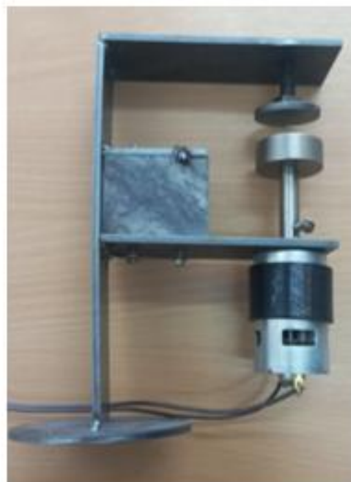
4-rasm. Yeyilish jadalligini aniqlash uchun tajriba qurilmasi sxemasi
