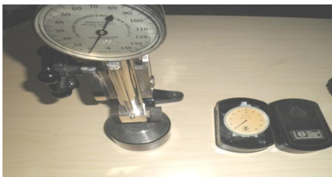
4 – rasm. TIR – 2033 markali tarkibli tepki rezinali amortizator qattiqligini o‘lchash uskunasi
