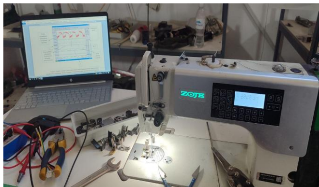
1 –rasm. Tavsiya qilingan tarkibli amortizatorli tepkini tikuv mashinasi tajriba nusxasida o‘lchash uskunalari bilan keltirilgan ko‘rinishi
