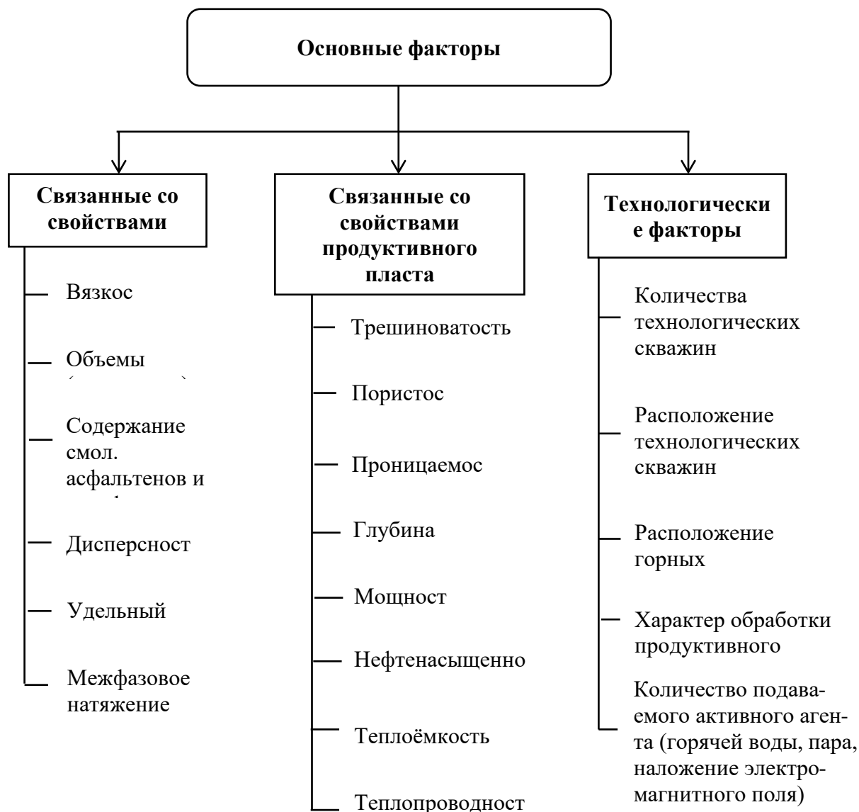
Рис.1. Группировка основных факторов, определяющих эффективность шахтного освоения месторождений высоковязкой нефти.
