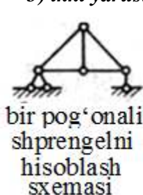
13- rasm. Shprengelli fermalar a) bir yarusli shprengelli b) ikki yarusli shprengelli
