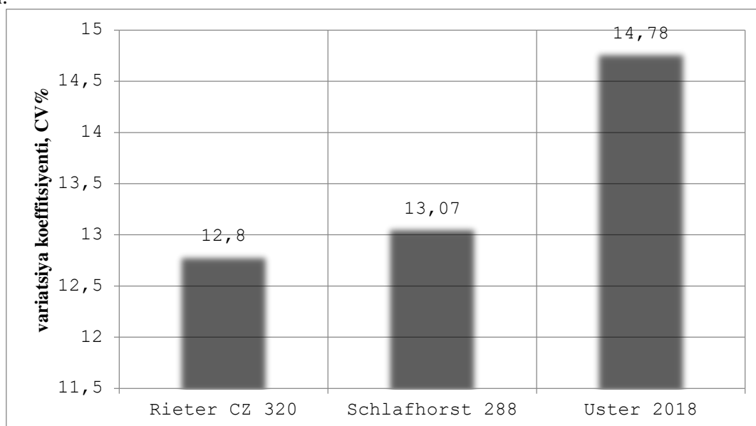
3-rasm. Turli rusumli pnevmomehanik yigirish mashinalarida yigirilgan iplarning chiziqli zichligi bo'yicha variatsiya koeffitsiyenti. 1- Rieter CZ 320, 2-Schlafhorst 288; 3-Uster statistics 2018 ko'rsatkichlari 50%
