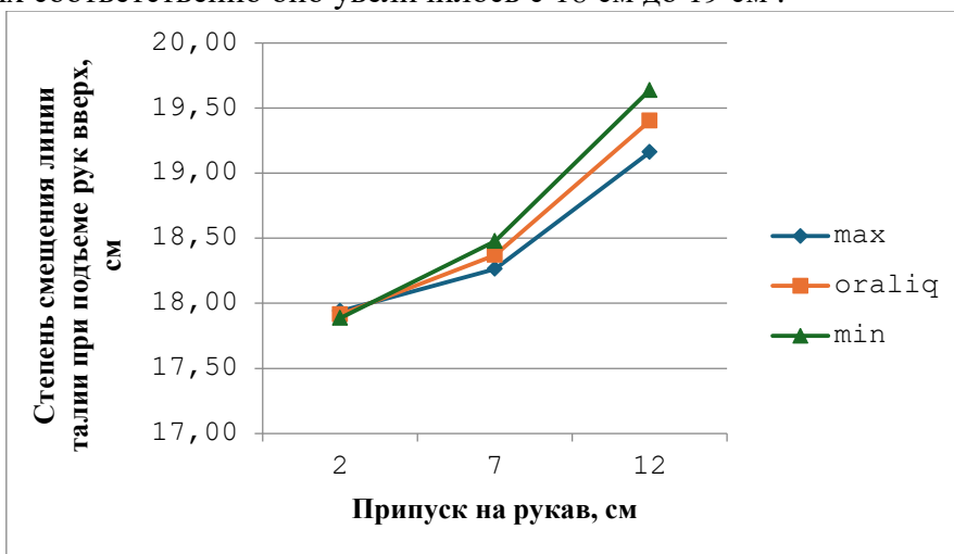
Рисунок 6. График зависимости величины дополнительного припуска на свободу рукава от степени смещения линии талии при подъеме рук вверх
