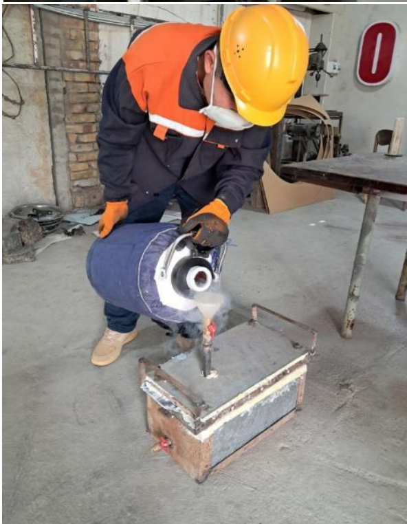
5-rasm. Burg'ilash qulflarining mustahkamligi va qattiqligini oshirish maqsadida termik va kriogen ishlov berish jarayoni
