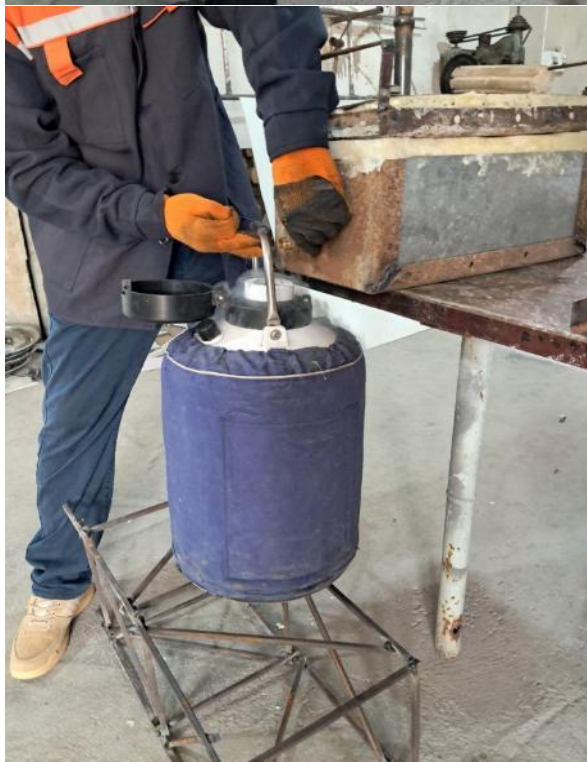
5-rasm. Burg'ilash qulflarining mustahkamligi va qattiqligini oshirish maqsadida termik va kriogen ishlov berish jarayoni
