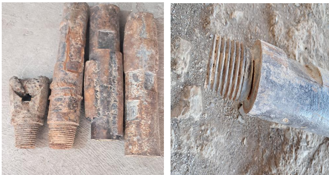
1-rasm. Qulfli ulanma qismlari yemirilganlik holatlari
