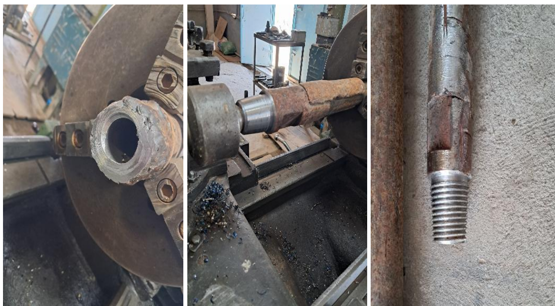
3-rasm. Qulfli ulanma qismlarni qayta tiklash jarayoni
