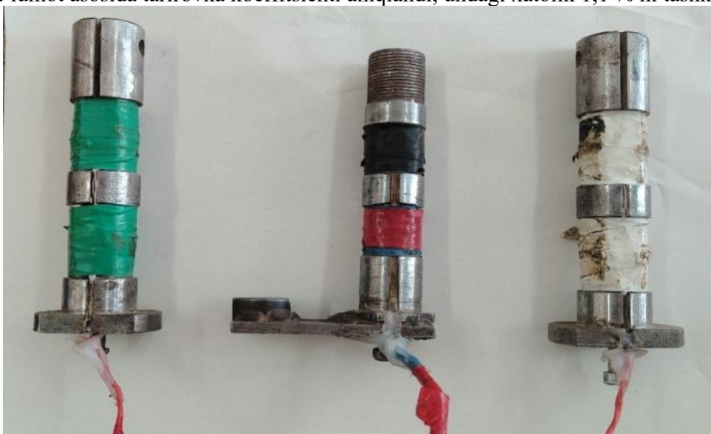
1-rasm. Tenzobarmoqlarning umumiy ko'rinishi. 1, 3 – pastki o'ng va chap tenzobarmoqlar; 2 – yuqorigi tenzabarmoq
