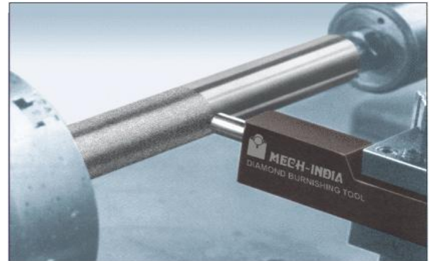
2-rasm. Tokarlik dastgohida tayyorlanma-ning tashqi sirtiga olmosli silliqlagich bilan ishlov berish
