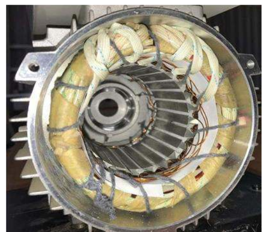
1-rasm. Asinxron motorning stator pazlariga tokni kuchlanishga o'zgartiruvchi o'zgartkichning sezgir elementini joylashtirilishi.
