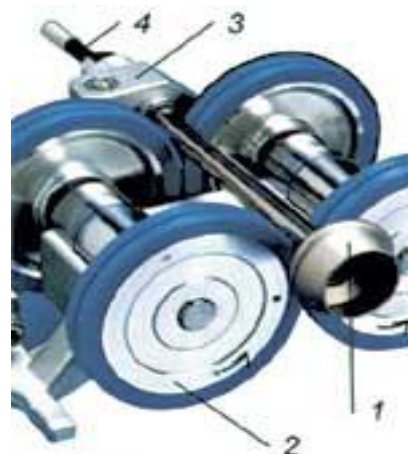
2-расм. Аероротор механизми. 1–ротор; 2-таянч ролиги; 3-ҳаво ёстиқчали подшпник; 4-сиқилган ҳаво таъминоти
